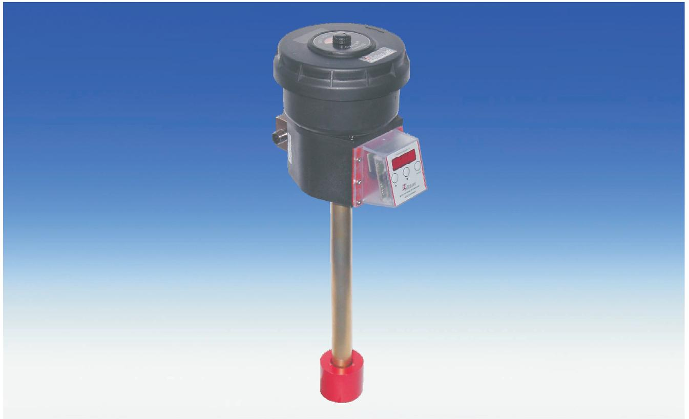
Le Nivovent 75 DC équipé de la technologie easyjust de Bühler est une combinaison compacte composée d'un filtre d'aération, d'une surveillance de niveau et d'un indicateur de précision mesurant la température pouvant être muni de deux sorties d'alarme réglables.
