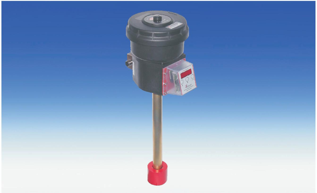
Der Nivovent 75 DC mit der Bühler Easyjust-Technologie ist eine kompakte Kombination bestehend aus einem BelüftungsfILTER, Niveauüberwachung und der genauen Messung und Anzeige der Temperatur mit bis zu zwei einstellbaren Alarmausgängen.
