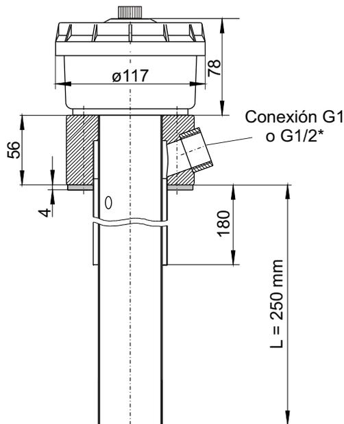
\*Conexión G1/2 por medio de la pieza de reducción correspondiente
