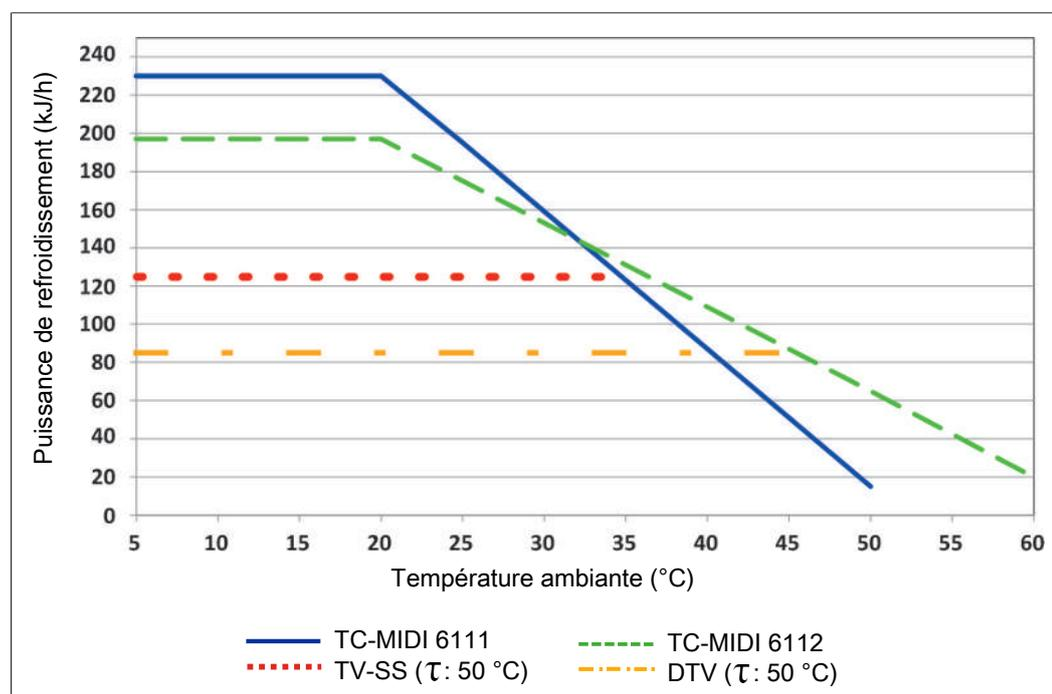
Remarque : Les courbes limites pour les échangeurs thermiques s'appliquent pour un point de rosée de 50 °C.
