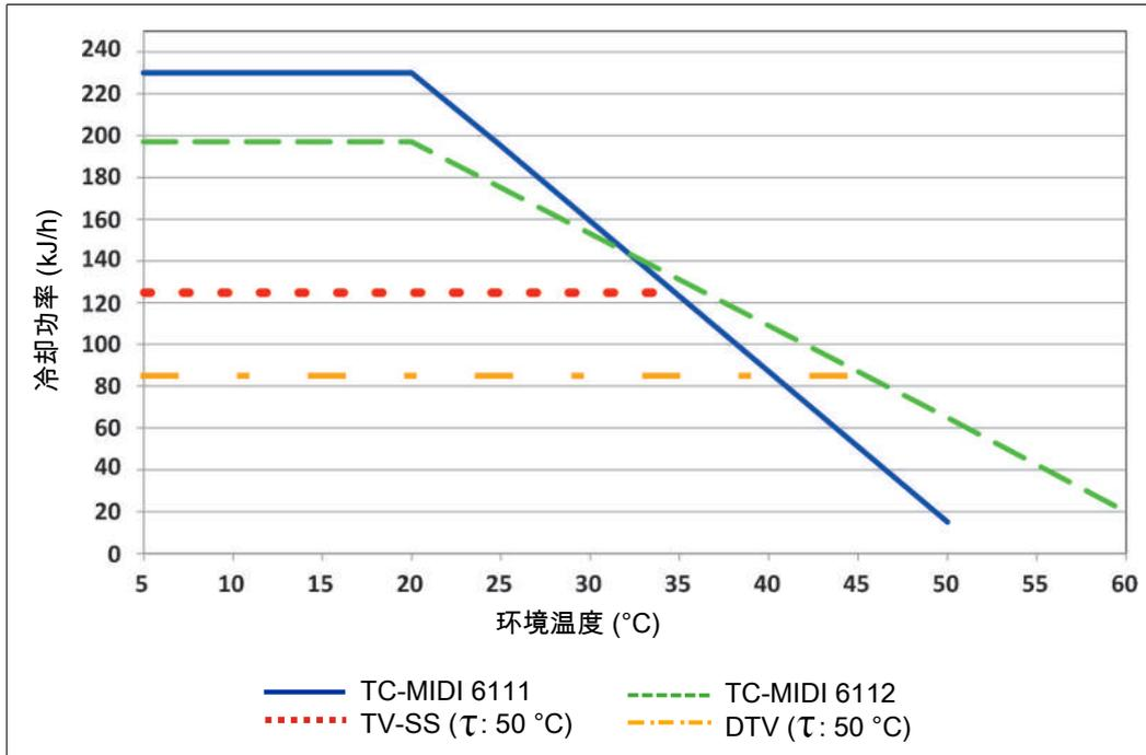
注释：换热器的极限曲线适用于50 °C的露点下。
